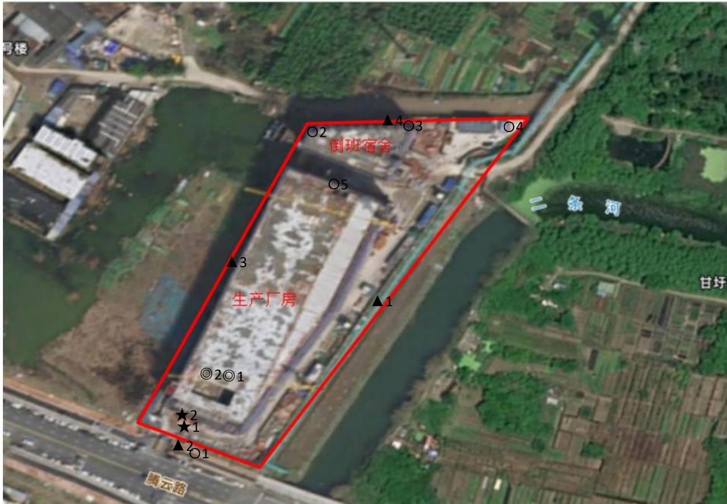
◎为有组织废气监测点位，○为无组织废气监测点位，★为废水和雨水监测点位，▲为噪声监测点位
