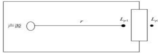
图 4-4 室内声源等效为室外声源图例
