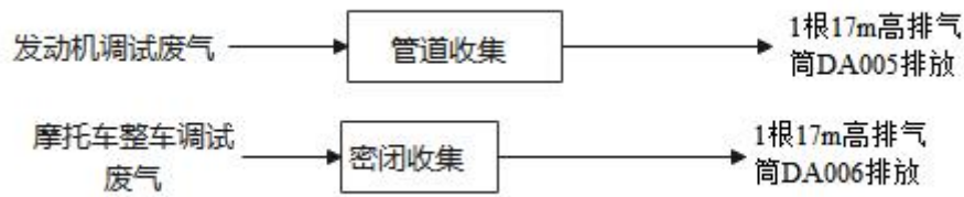
图 4.1-3 测试废气处理工艺流程图
